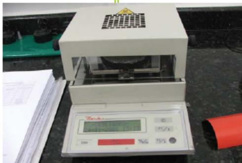
Balança de infravermelho
