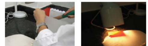
Nesse teste, o adesivo é pesado em uma balança analítica digital. Depois o adesivo é retirado e o filme é pesado para verificar se a quantidade de adesivo aplicado está correta.
