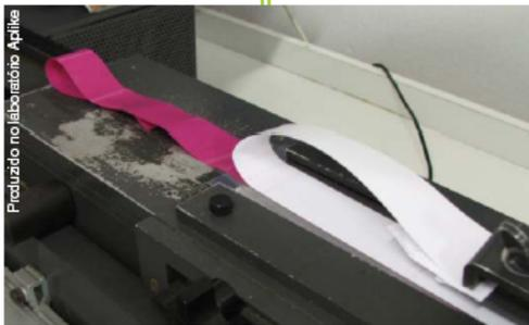
Teste de release verifica a força necessária para separar o adesivo do liner
