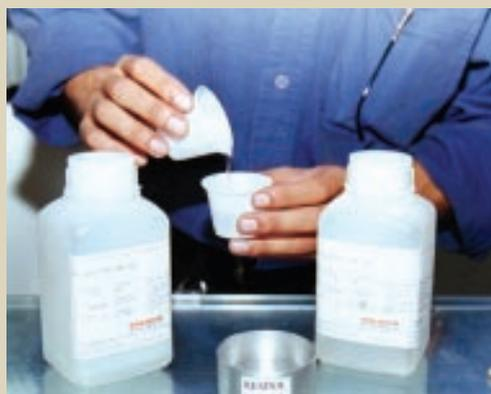
**4.** Enquanto as chapas são aquecidas prepare a solução juntando a resina rígida e o endurecedor na proporção de 2:1, respectivamente. Não prepare muita quantidade, pois a resina endurece rapidamente
