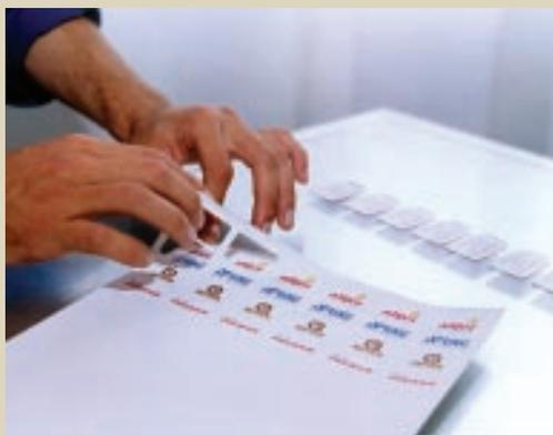
**1.** Depois de imprimir as etiquetas em impressora inkjet, retire a máscara do vinil para iniciar a resinação
