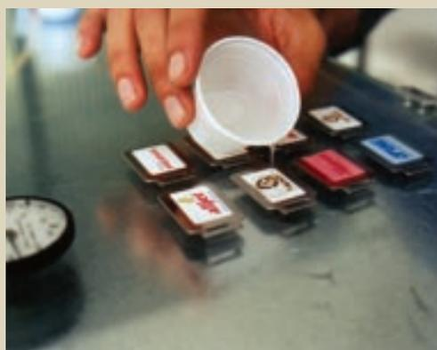
**6.** Despeje uma pequena quantidade da solução sobre a placa. Não se preocupe, pois a resina se molda ao tamanho da placa. Caso se formem bolhas, espete-as com um palito
