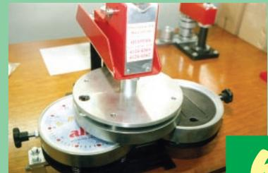
Do outro lado é colocada a base plástica. Prensam-se primeiro os três componentes e, depois, a base plástica.
