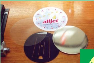
Para a montagem são usados: base plástica, superfície metálica, papel impresso e um filme de poliéster para proteção.
