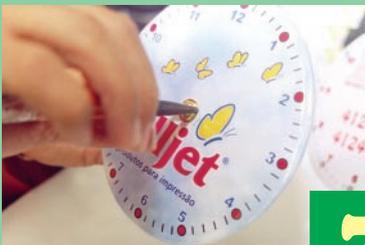
Com o relógio prensado, ele precisa ser furado e nele são colocados uma porca e um parafuso.
