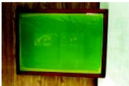
Depois de gravada, a tela deve ser revelada. Para isso, ela precisa ser lavada com jatos de água. Depois disso, é preciso secá-la para iniciar a impressão.
