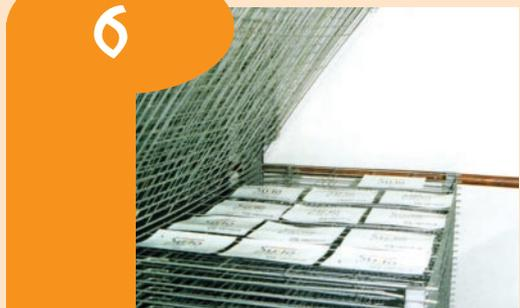
O magneto é colocado em secadores metálicos. A secagem é rápida ao toque, mas a empilhagem não deve ser imediata.
