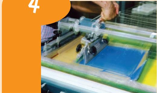
Depois de preparar a tinta à base de solvente e colocá-la sobre a tela, basta imprimir.
