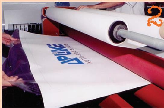
Após a regulagem, a peça a ser laminada é colocada no equipamento e passa pelos roletes para receber o filme de laminação
