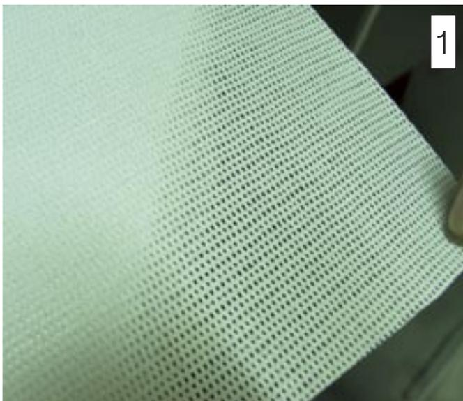
O tecido é produzido à base de poliéster, com revestimento em PVC, o que permite a ancoragem da tinta na impressão digital
