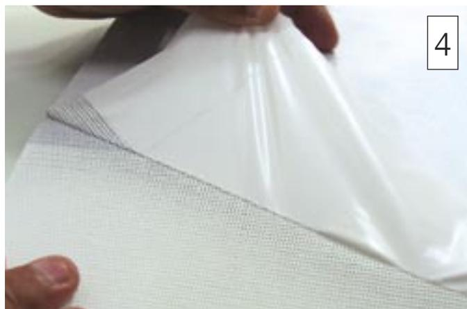
4 O material acompanha um liner de proteção, que deve ser mantido durante a impressão e retirado apenas no acabamento da peça
