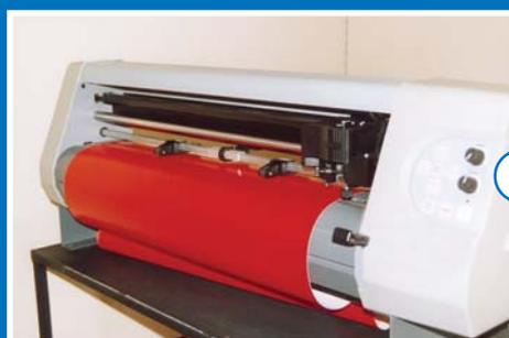
2- Em seguida, coloque no plotter de recorte o vinil auto-adesivo a ser recortado.
