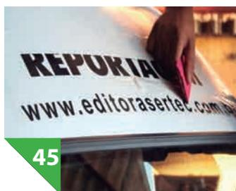
Com todas as partes do carro devidamente adesivadas, as letras recortadas (em máscara de transferência) devem ser aplicadas
