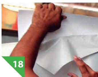
Para a adesivação, separe o vinil (a ser adesivado à superfície do veículo) do liner (a ser dobrado por trás do vinil)
