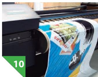
O tipo vinil utilizado para a adesivação desse passo-a-passo foi o calandrado. A impressora foi a jato de tinta à base de solvente
