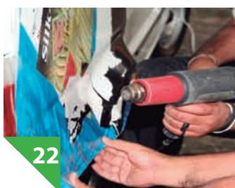
Em determinadas áreas, utilize o soprador térmico para moldar melhor o adesivo à superfície, mas não utilize demais essa ferramenta, pois ao secar, o vinil calandrado pode se retrair e até mesmo romper
