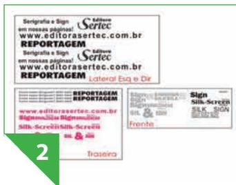
Se a adesivação do veículo envolver a aplicação de textos chapados, crie um arquivo digital contendo somente esses textos. Agrupe-os conforme o local onde serão aplicados, recorte-os (plotter de recorte) e aplique-os sobre o vinil já adesivado no veículo (ver passos 45 a 47)
