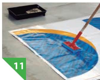
Como o veículo sofre a ação de intempéries, aplique (com um rodo específico) um verniz à base de água (pois a tinta é à base de solvente), com proteção ultravioleta. Todas as partes impressas devem receber uma camada de verniz
