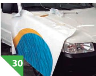
O próximo passo é a aplicação do adesivo na área lateral dianteira, próxima à roda. Posicione corretamente o vinil nessa parte, a fim de evitar que a imagem fique torta
