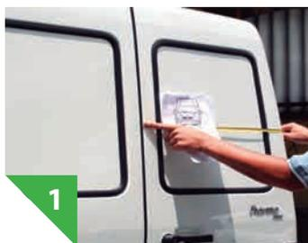
Tire todas as medidas do veículo a ser adesivado. A partir delas, utilizando um software para ilustrações vetoriais, crie moldes das laterais e partes frontal e traseira do veículo, que servirão de referência para a composição do arquivo digital
