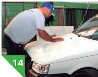
Limpe o veículo antes de iniciar a adesivação. Ele deverá estar completamente livre de impurezas. Recomenda-se a aplicação de um desengraxante em todo o veículo
