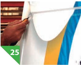
Como a aplicação foi realizada com vinil calandrado, há a necessidade de 'filetar' as áreas com curvas e depressões. Com o estilete, corte o vinil na área do vinco, para que ele fique esticado
