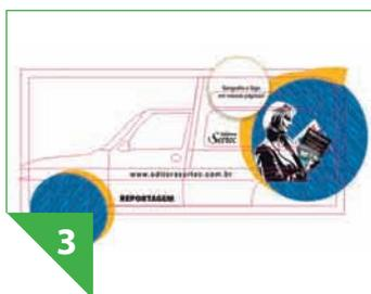
Para a composição do arquivo digital, utilize softwares de tratamento de imagem e ilustrações vetoriais. Combine os moldes do veículo (passo 1) com as imagens a serem impressas. Veja ao lado a combinação do molde da lateral esquerda com a imagem a ser aplicada
